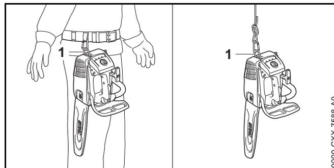
Моторният трион може да се транспортира чрез ухото (1) на колана или с помощта на въже.
